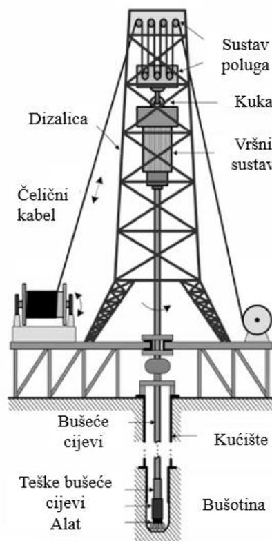
Slika 6 Shema platforme za bušenje nafte [9]
