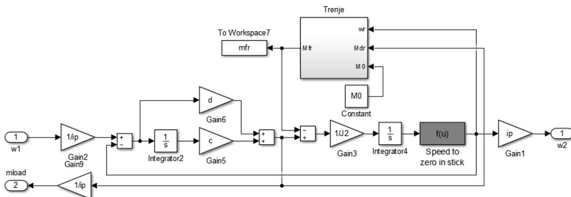
Slika 16 Simulink model buševićeg vretena [13]
