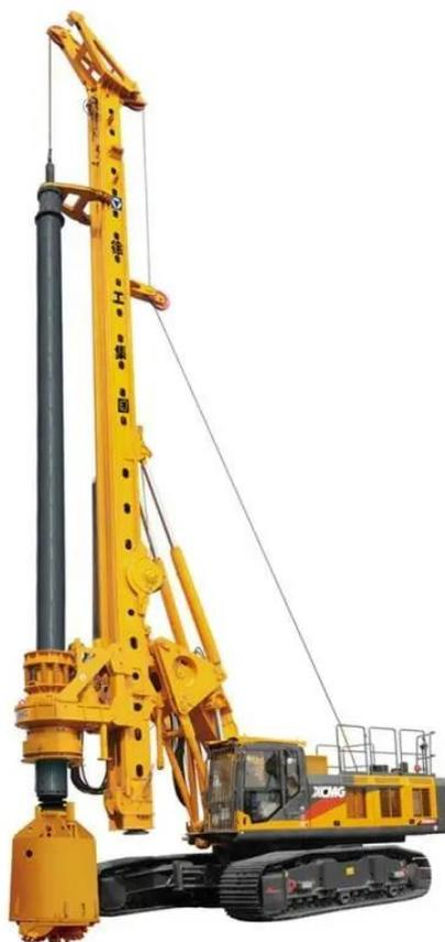
Slika 8 Stroj za rotirajuće bušenje [11]
