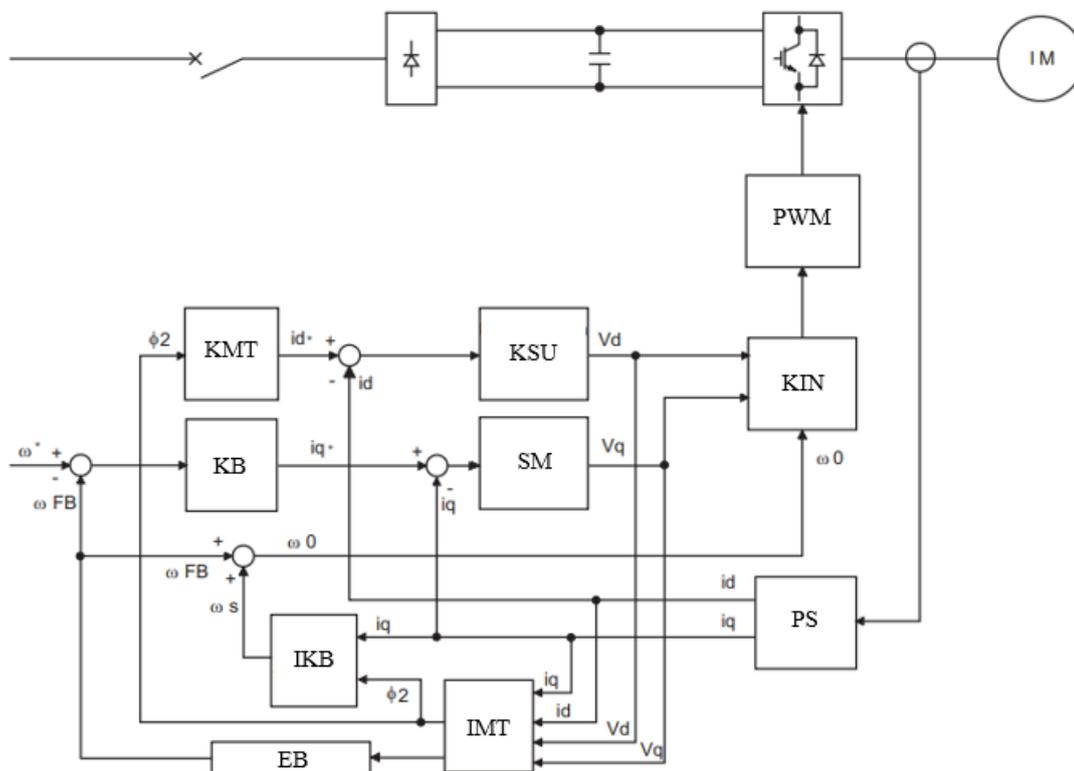
Slika 73 Blok dijagram bez senzorske vektorske kontrole [17]
