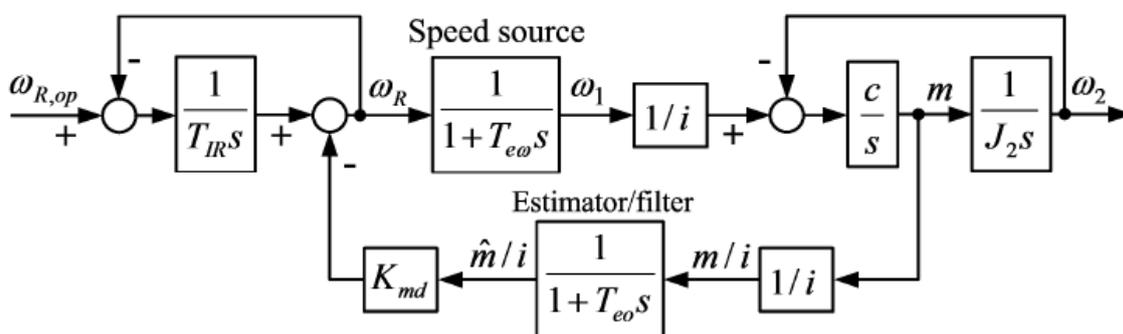
Slika 18 Pojednostavljeni blok dijagram vanjskog prigušenja vibracija [1]
