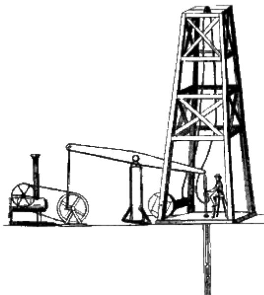
Slika 7 Bušenje kablskim alatom [10]
