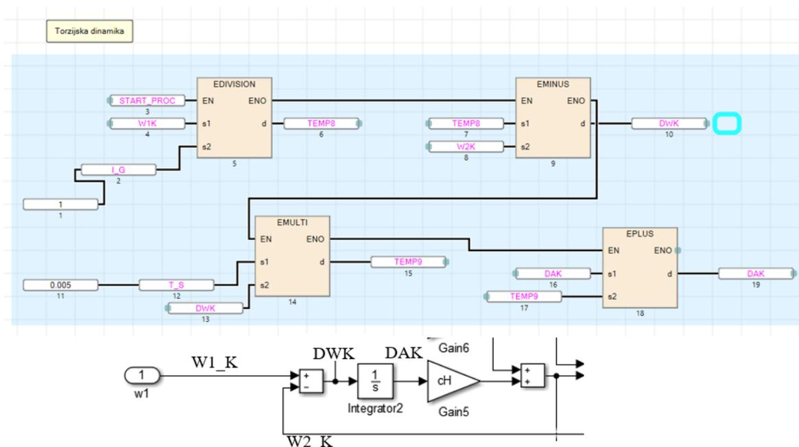
Slika 36 Torzijska dinamika GX Work3 i Simulink
