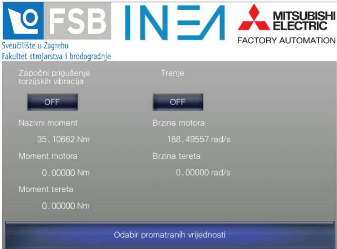
Slika 69 Zaslon prigušenja torzijskih vibracija
