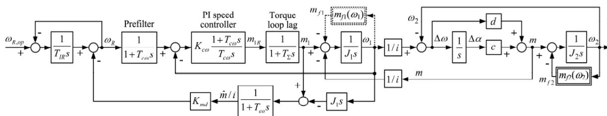
Slika 17 Blok dijagram sustava za prigušivanje vibracija [1]
