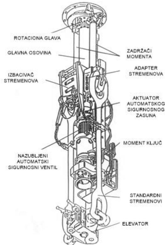
**Slika 13 Sklop za navrtanje i odvrtnje [12]**
