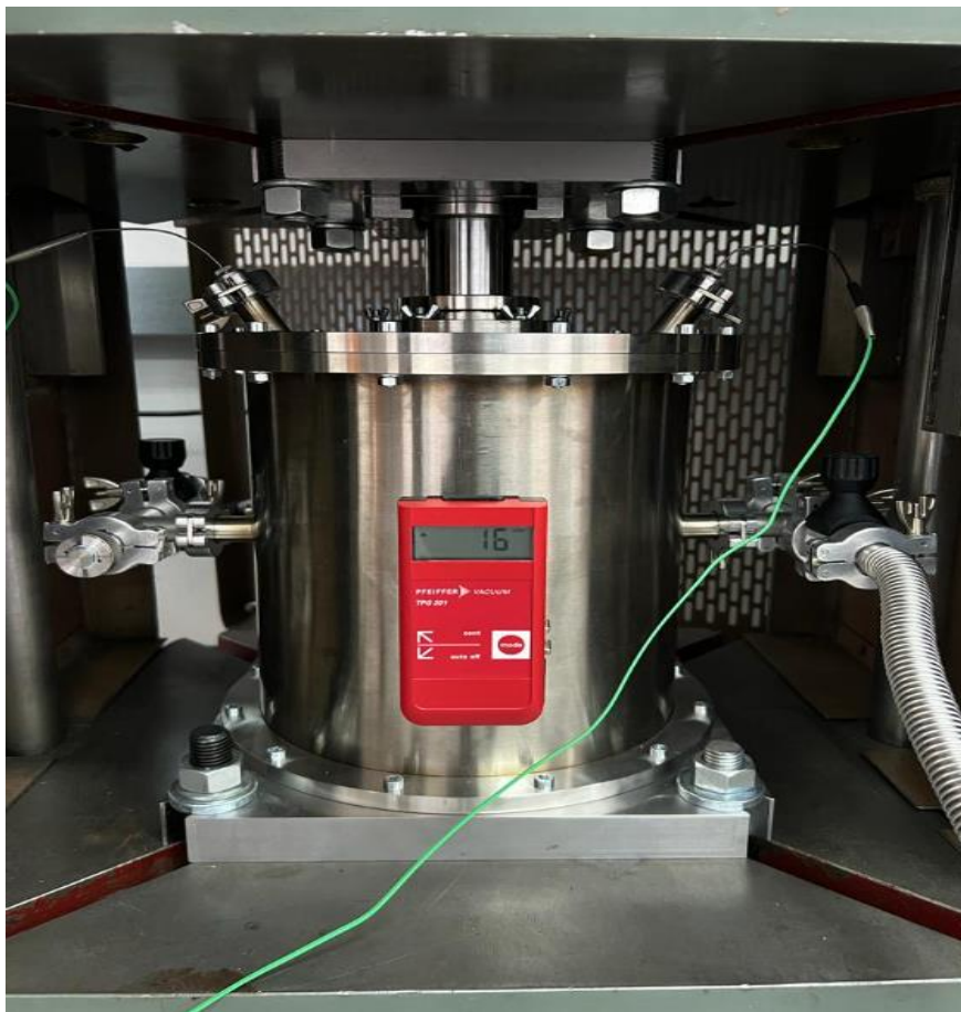
Slika 16. Vakuumska posuda s temperaturnim senzorima
