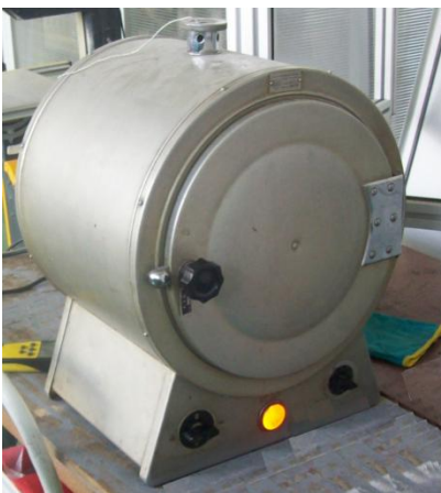
Slika 4.10 Električna peč za predgrijavanje obradaka
