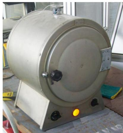
**Slika 4.10** Električna peć za predgrijavanje obradaka
