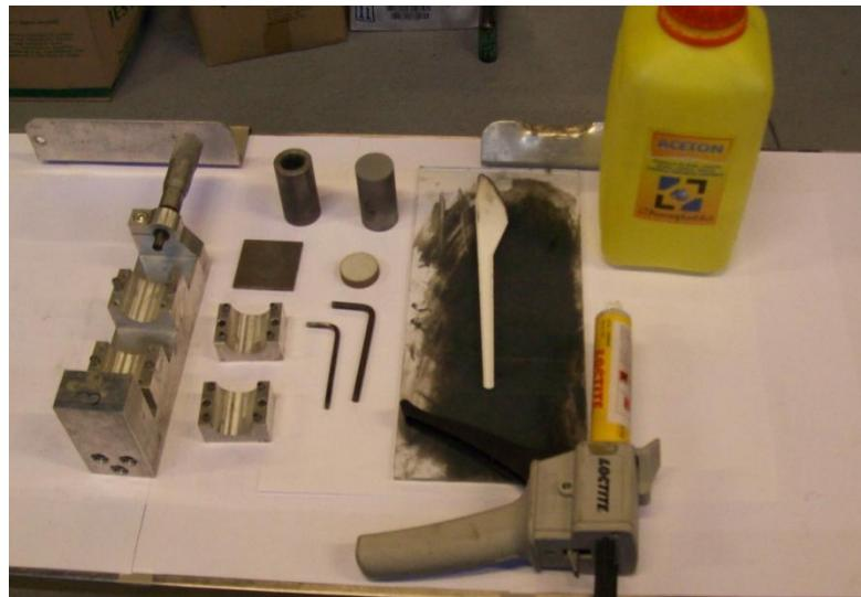
**Slika 4.16** Oprema za lijepljenje epruvete u svrhu ispitivanja prionljivosti
