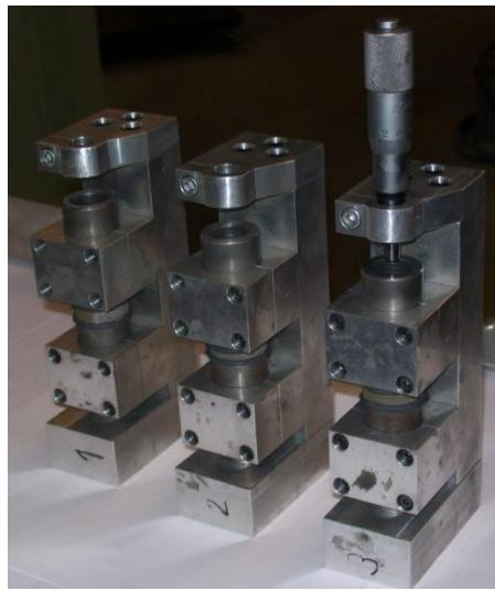
**Slika 4.17** Zaljepljene epruvete u fazi sušenja
