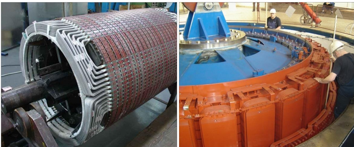
Slika 12 – cilindrični rotor (lijevo) i rotor s istaknutim polovima (desno)
