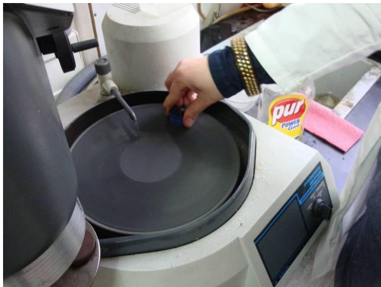
Slika 53. Brušenje i poliranje uzoraka.
