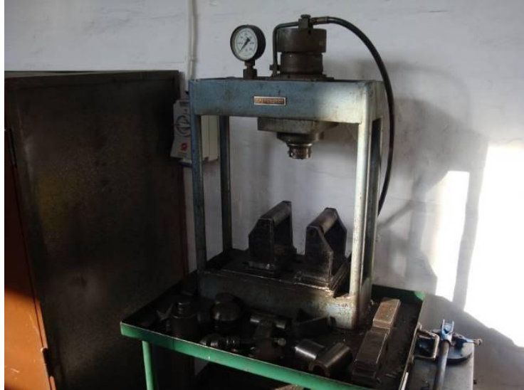
Slika 44. Naprava za savijanje uzoraka.
