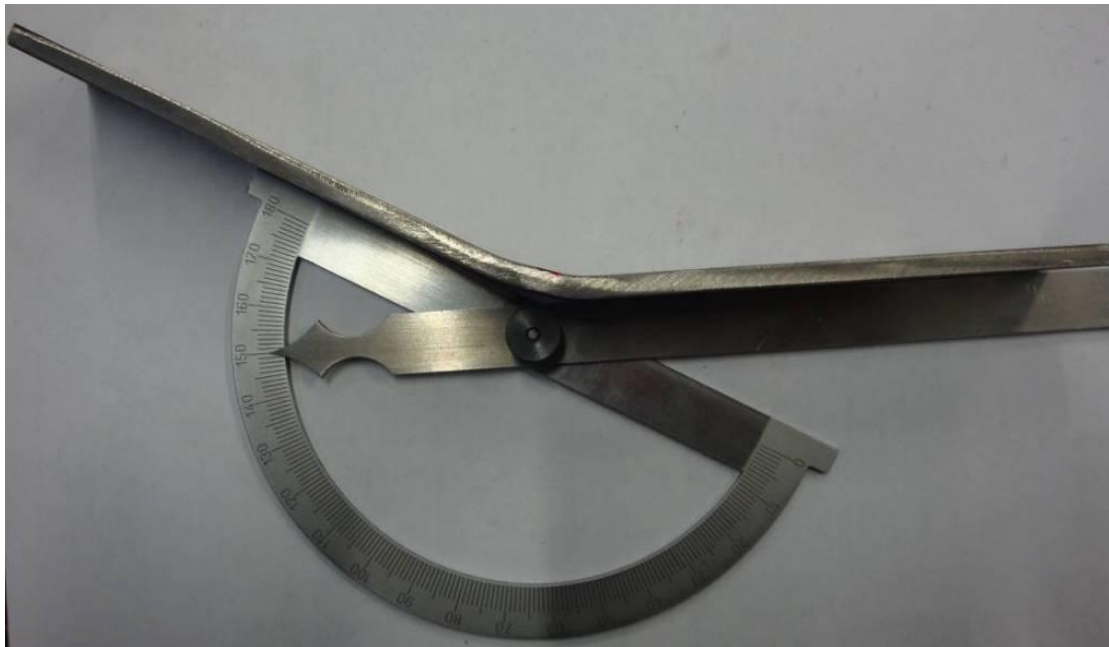
Slika 49. Savijeni uzorak P4A na korijen zavora.
