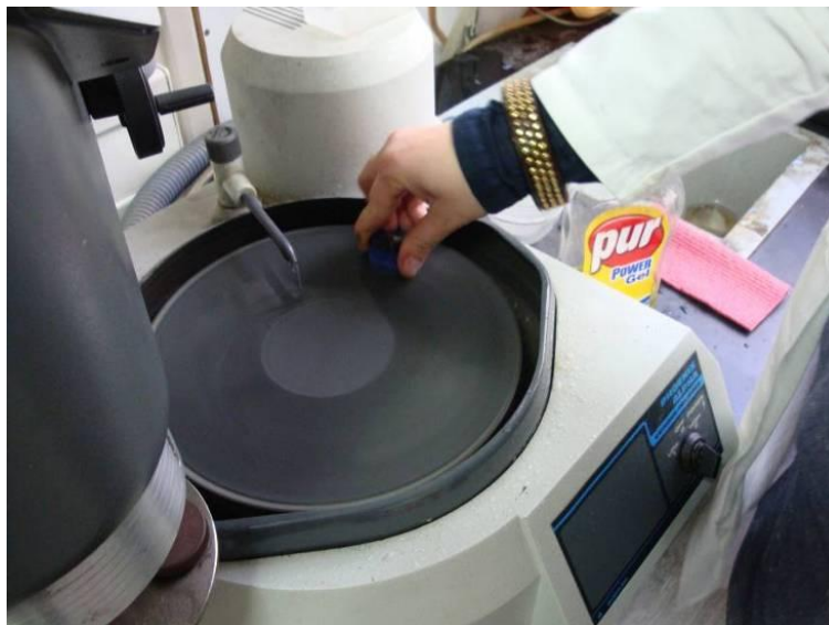
Slika 53. Brušenje i poliranje uzoraka.
