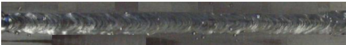
Slika 32. Pokus P1M, lice zavora.
