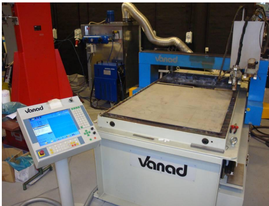
Slika 9. CNC plazma rezačica VANAD PROXIMA 10/200.
