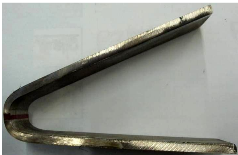
Slika 47. Maksimalno savijen uzorak.
