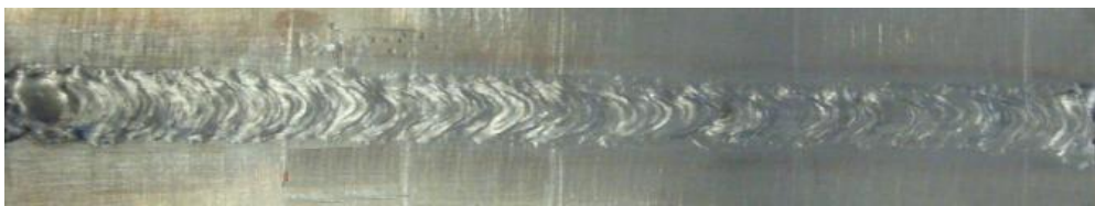
Slika 22. Pokus P1A, lice zavara.
