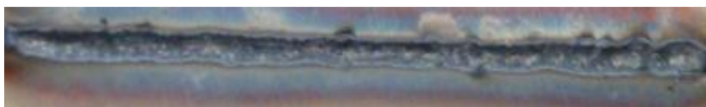
Slika 29. Pokus P4A, korijen zavara.
