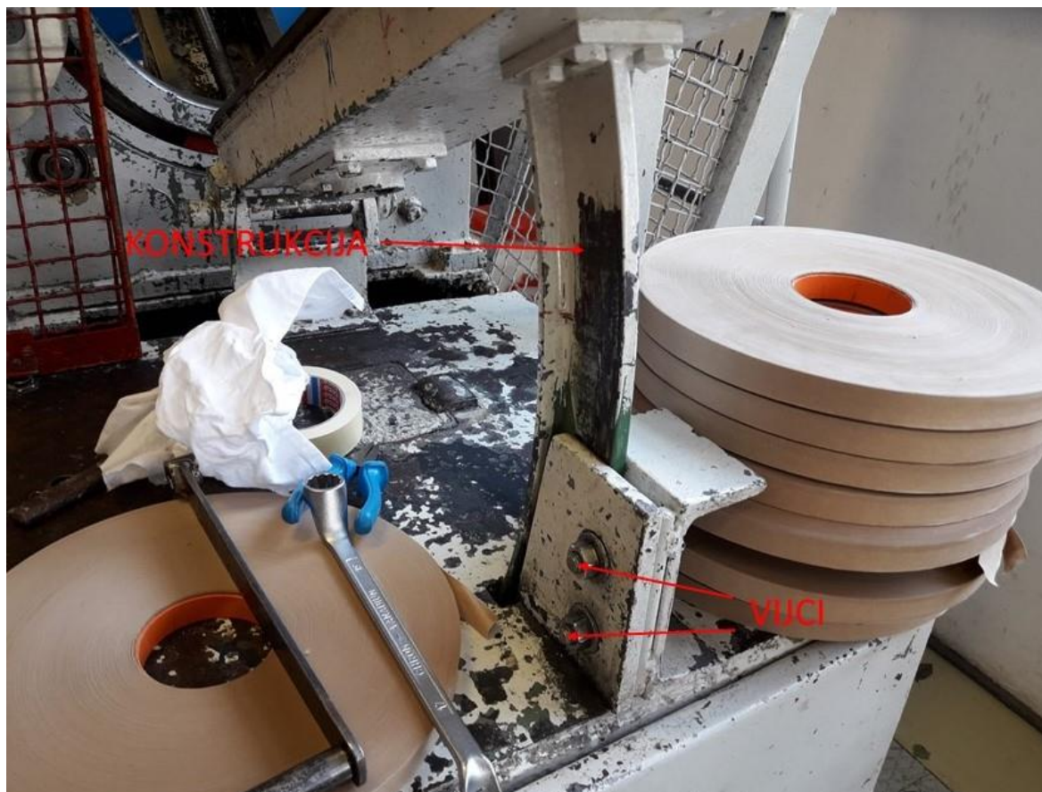
Slika 30. Vijci koji drže konstrukciju
