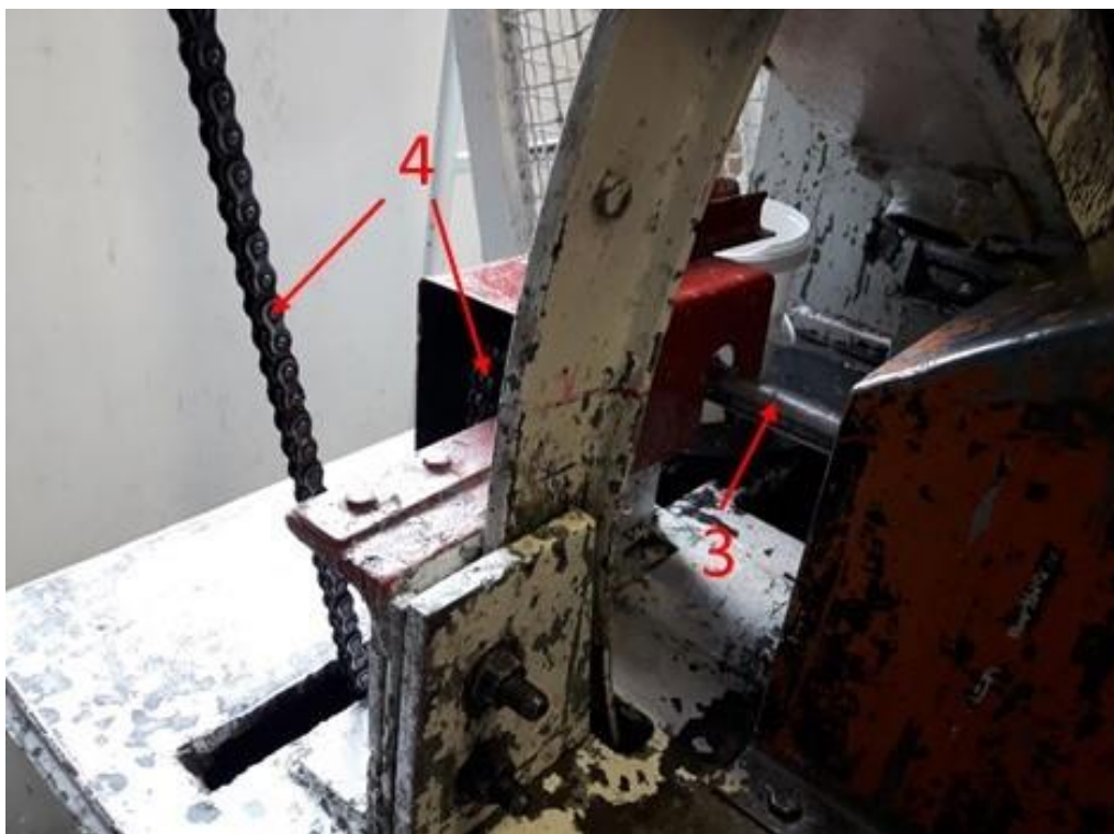
Slika 12. Sustav za okretanje (3 – vratilo, 4 – lančani prijenos)
