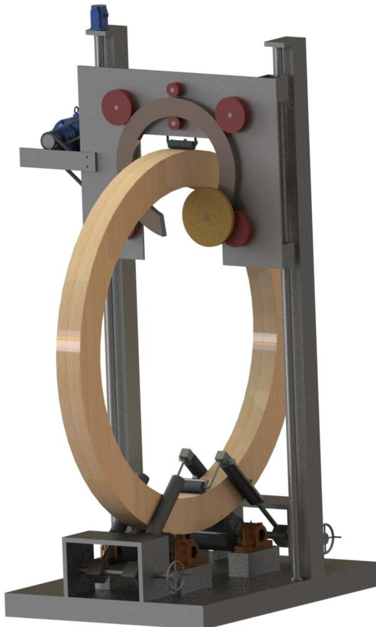
Slika 77. Koncept 2A - stroj za namatanje kapa s nanošenjem ljepila na namotani papir
