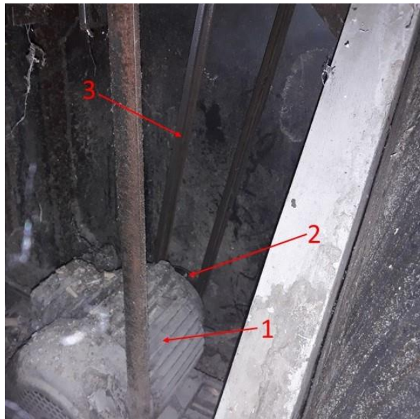
Slika 8. Elektromotor s remenskim prijenosom (1 - elektromotor, 2 - remenica, 3 - remen)
