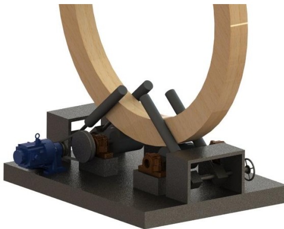
Slika 70. Koncept 1A - sustav za okretanje
