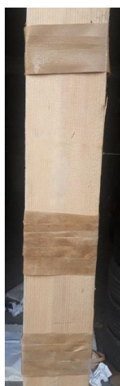
Slika 102. Segmenti namotani na drveni predložak (uspješni eksperimenti)
