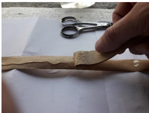
Slika 90. Prvi način - nanošenje ljepila pomoću papira
