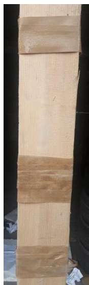
Slika 102. Segmenti namotani na drveni predložak (uspješni eksperimenti)
