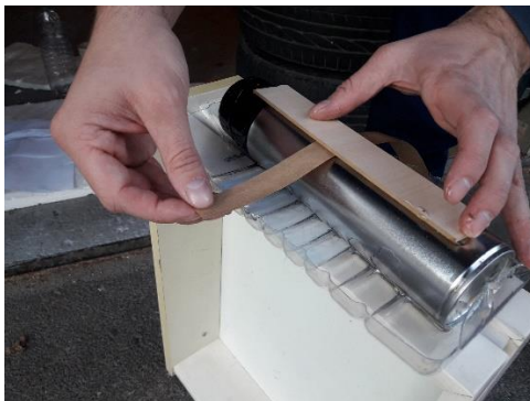
Slika 98. Treći način - uspješno nanošenje ljepila na papir
