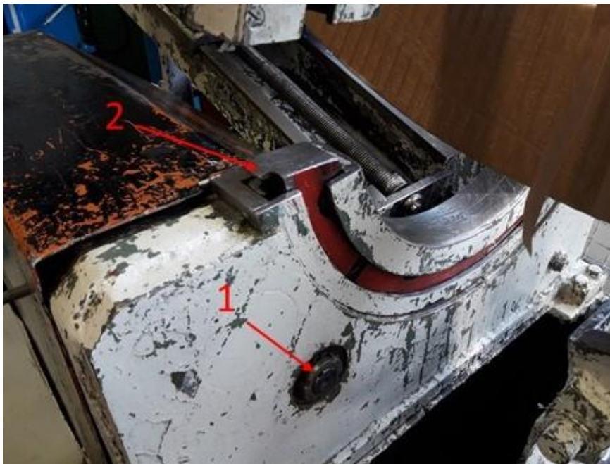
Slika 14. Sustav za namatanje (1 – vratilo, 2 – veliki zupčanik)
