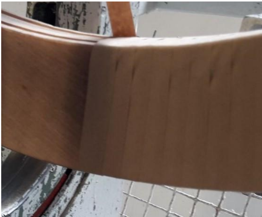
Slika 28. Nepravilno namatanje papira
