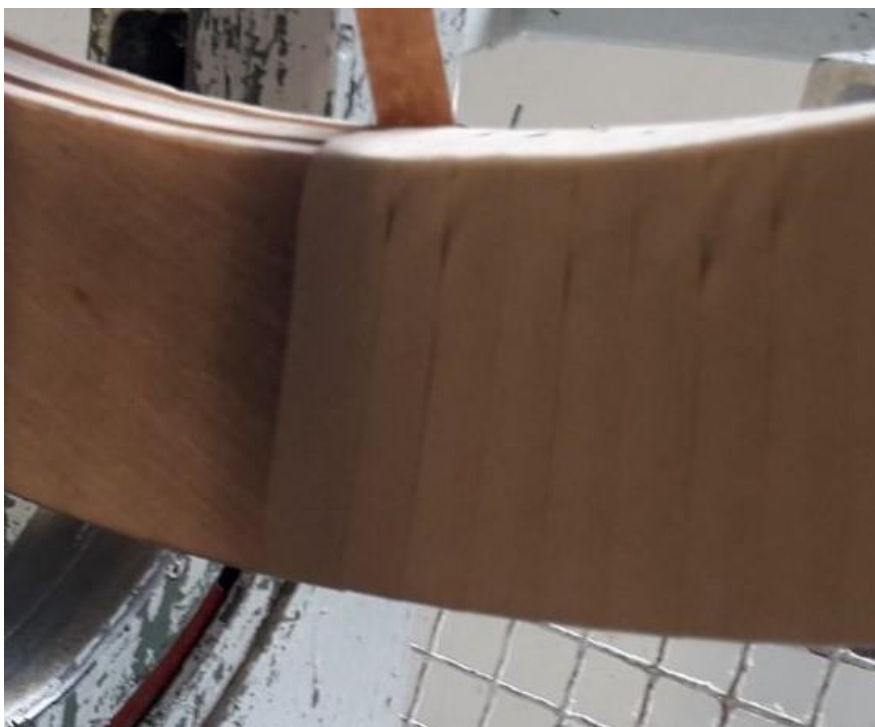
Slika 28. Nepravilno namatanje papira
