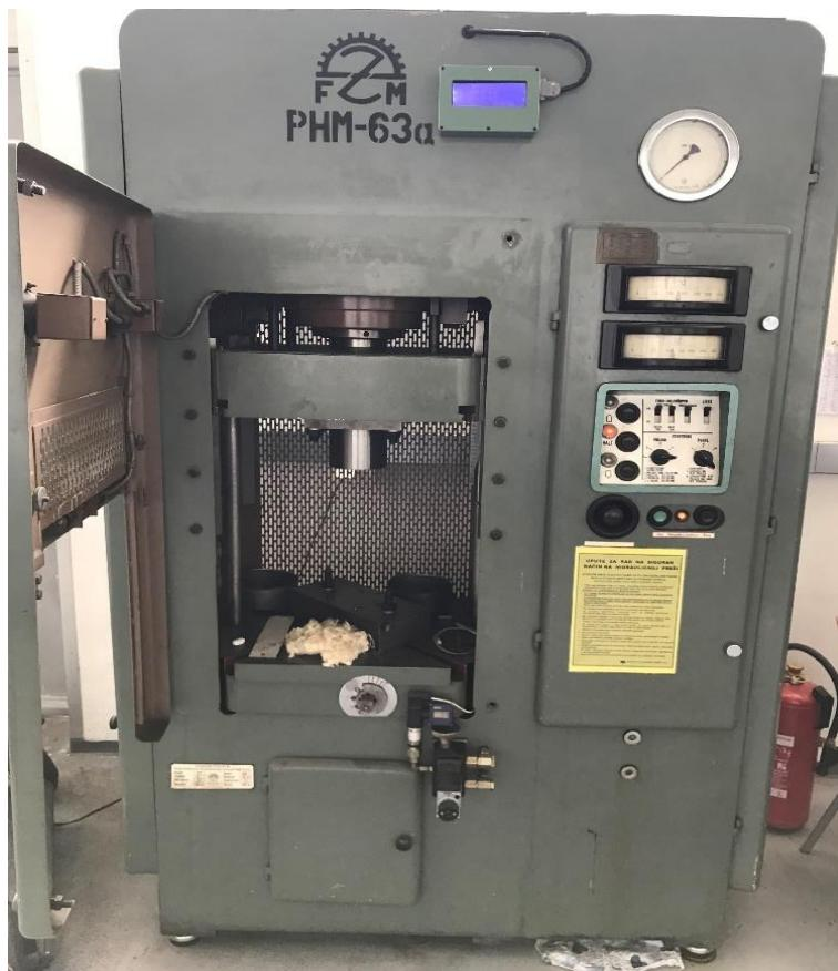
**Slika 30.** Stroj za hladno izostatsko prešanje
