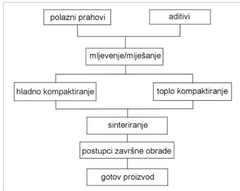
**Slika 5.** Konvencionalni postupci metalurgije praha [7]
