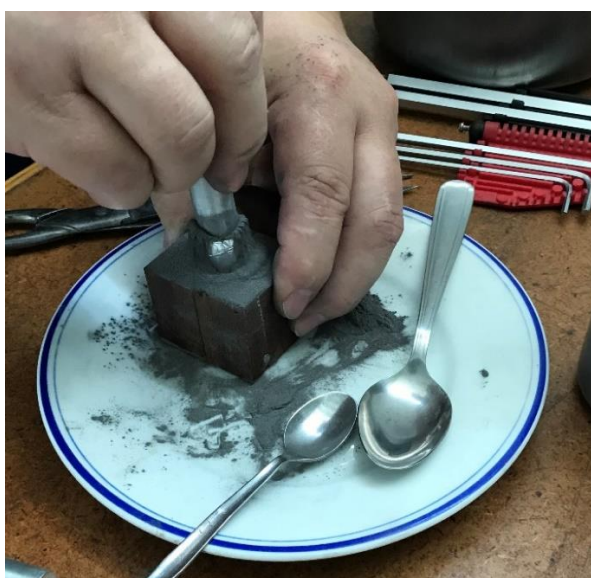
Slika 26. Sabijanje praha u ovitak od aluminijske folije
