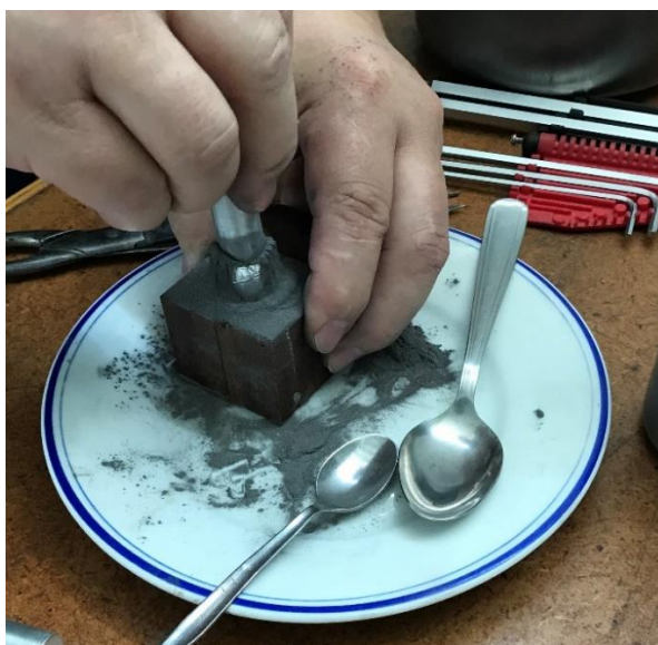
Slika 26. Sabijanje praha u ovitak od aluminijske folije
