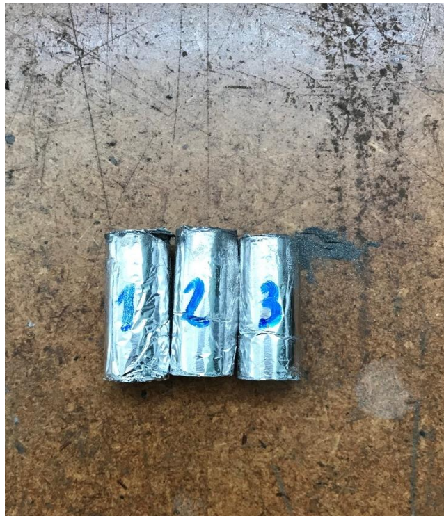
Slika 27. Uzorci nakon sabijanja u ovitke
