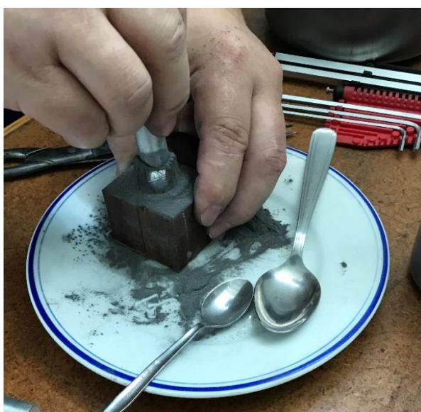
Slika 26. Sabijanje praha u ovitak od aluminijske folije
