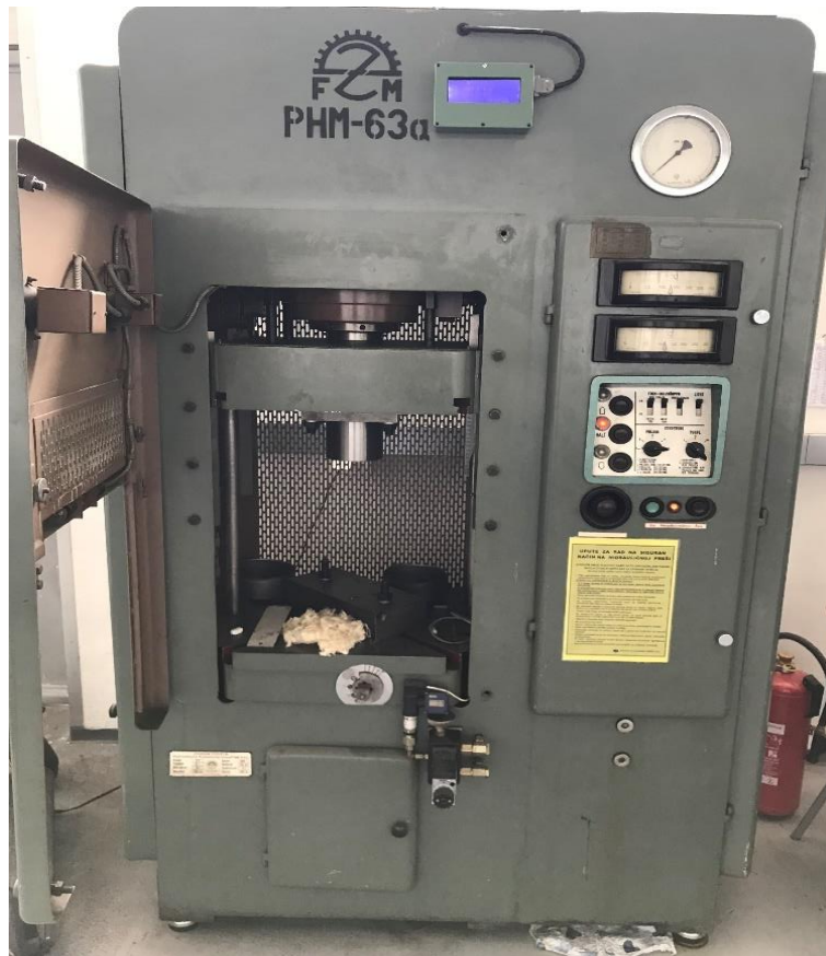
Slika 30. Stroj za hladno izostatsko prešanje
