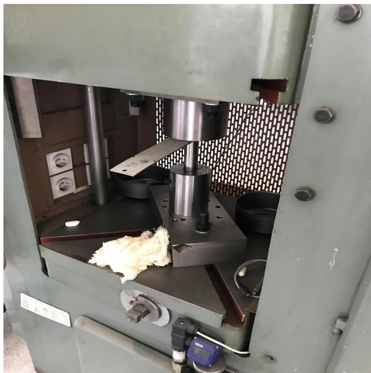
Slika 30. Stroj za hladno izostatsko prešanje
