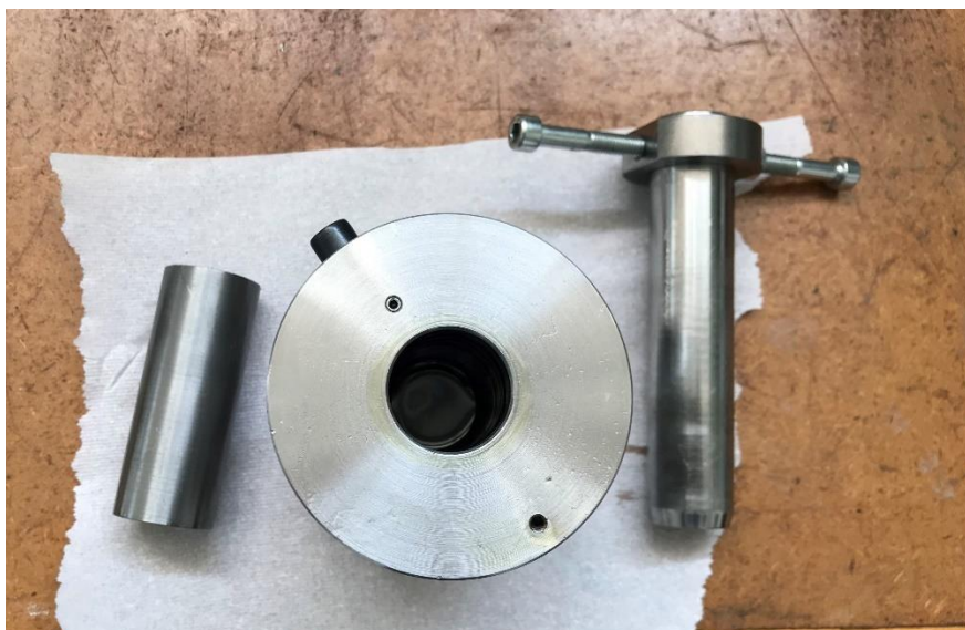
Slika 28. Alat u kojem se nalazi uzorak tijekom prešanja
