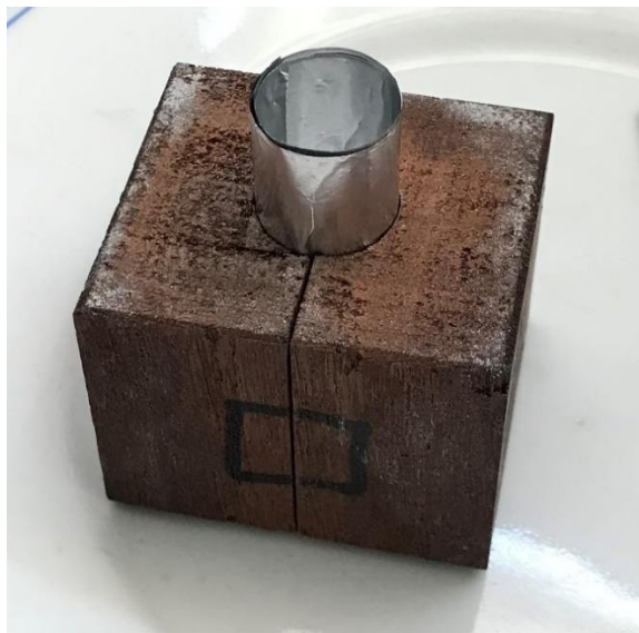
Slika 25. Kalup za ovitak od aluminijske folije
