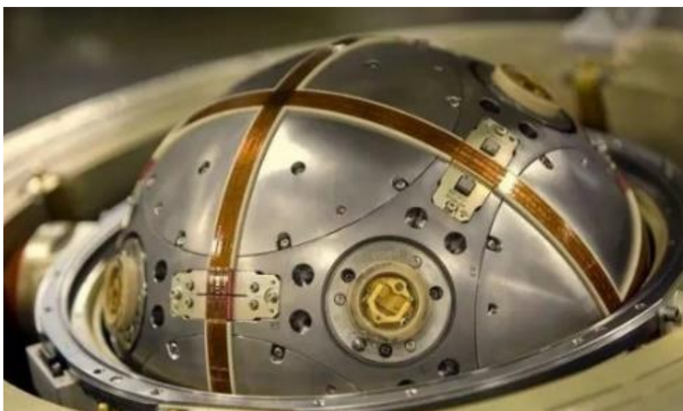
Slika 12: Inercijalni navigacijski uređaj balističke rakete [1]
