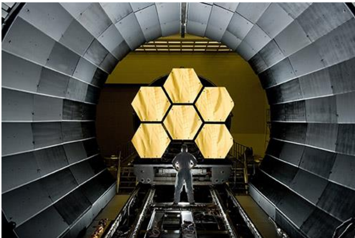
Slika 9: Berilijeva zrcala u svemirskom teleskopu [12]
