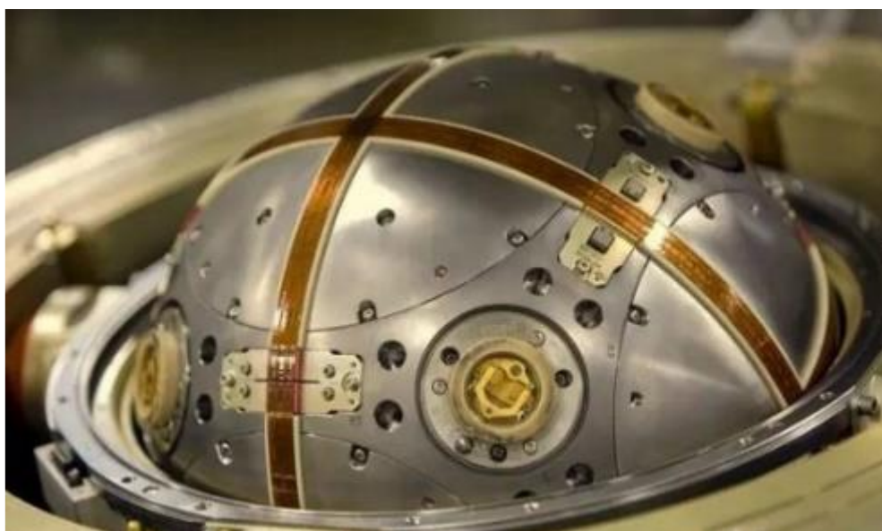
Slika 12: Inercijalni navigacijski uređaj balističke rakete [1]
