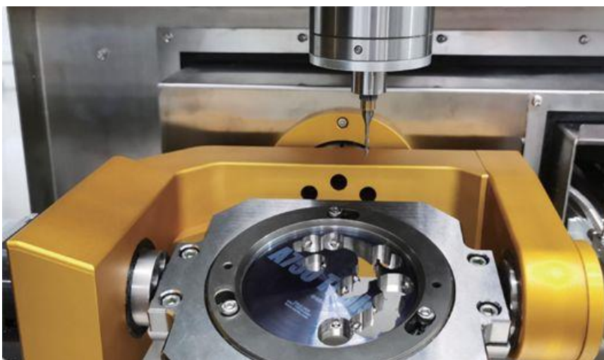
Slika 104. Unutrašnjost glodajućeg obradnog centra [70]
