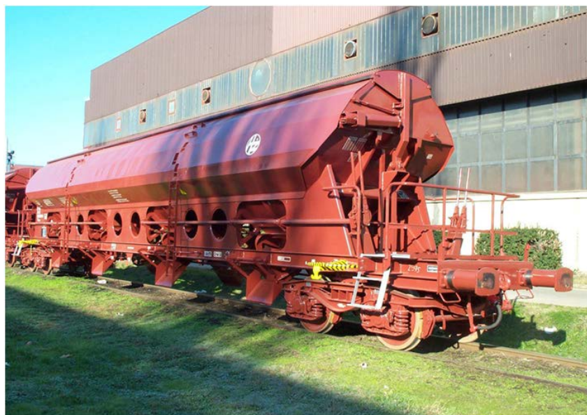
Slika 1. Teretni vagon Tadnss-z za prijevoz rasutog tereta [1]
