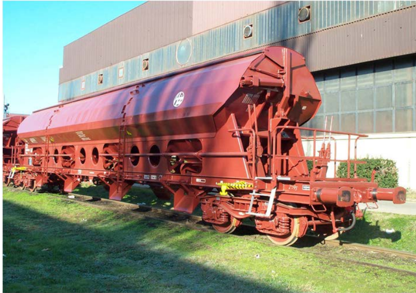
Slika 1. Teretni vagon Tadnss-z za prijevoz rasutog tereta [1]
