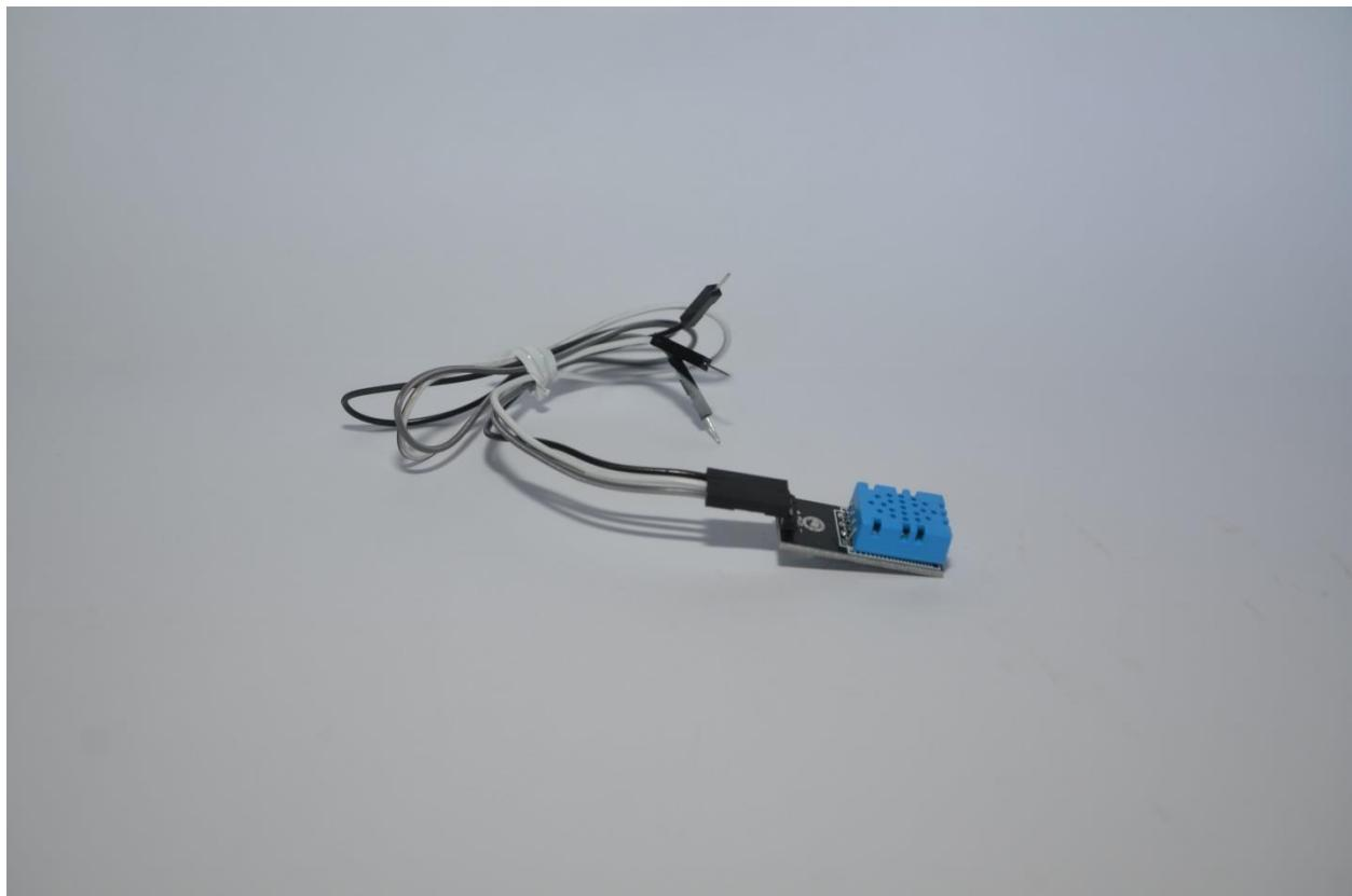
**Slika 7.** DHT11 senzor temperature
