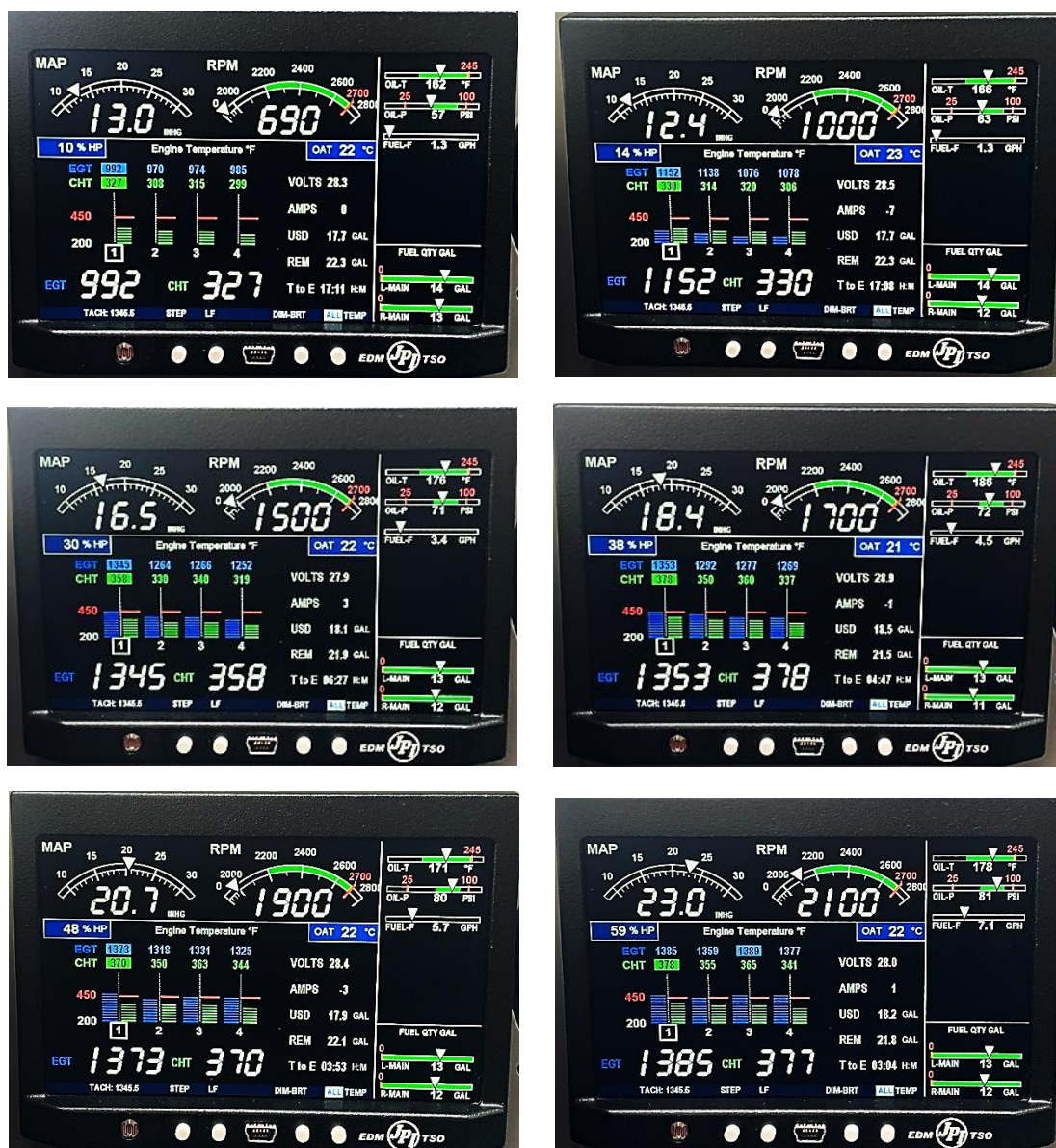
Slika 25. EDM uređaj pri odgovarajućim brzinama vrtnje motora za sve ispitne točke
