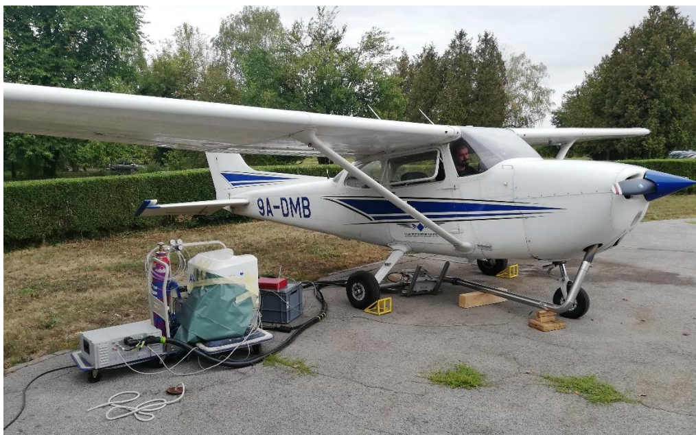
Slika 9. PEMS uređaj spojen na ispušni sustav zrakoplova 9A-DMB
