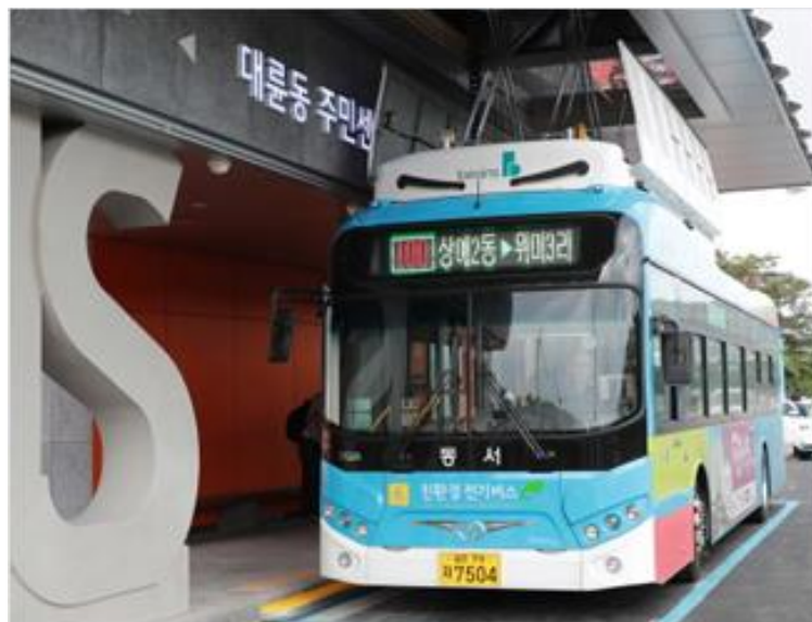
Slika 3. Stanica za izmjenu baterija električnog autobusa [3]
