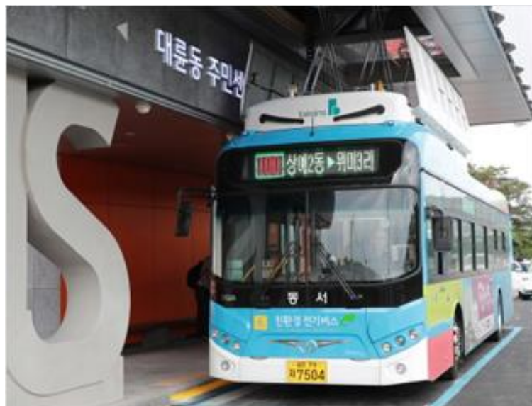
Slika 3. Stanica za izmjenu baterija električnog autobusa [3]
