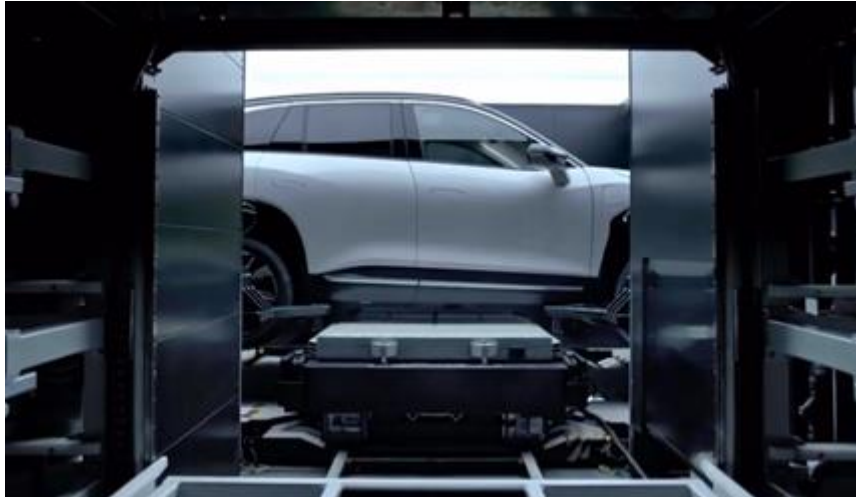
Slika 2. Sustav izmjene baterije [2]
