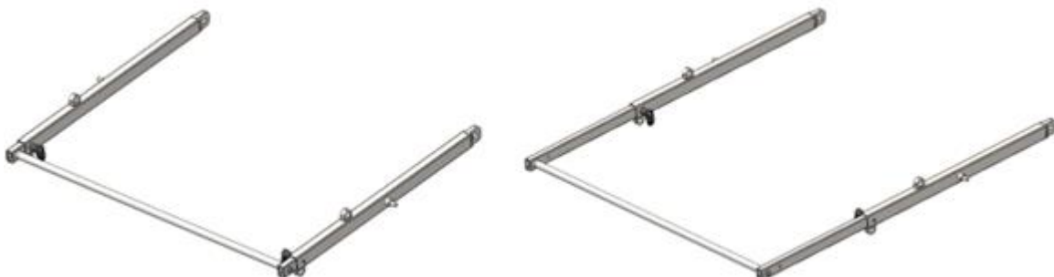
Slika 21. Sklop ručke u uvučenom i izvučenom položaju
