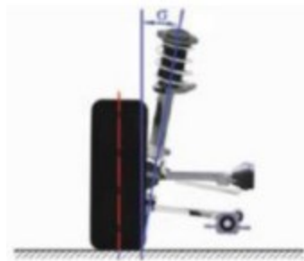
Slika 2.6 Bočni nagib osi zakretanja kotača [2]
