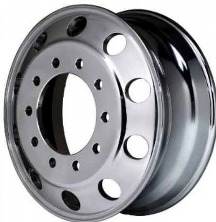
Slika 5.3 Naplatak Alcoa 17,5" x 6,75" [6]
