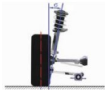
Slika 2.6 Bočni nagib osi zakretanja kotača [2]
