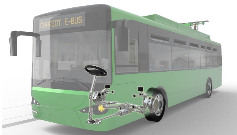
Slika 3.2 Prikaz vozila s upravljačkim mehanizmom ispred prednje osovine
