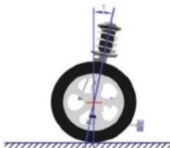
Slika 2.8 Uzdužni nagib osi zakretanja kotača [2]
