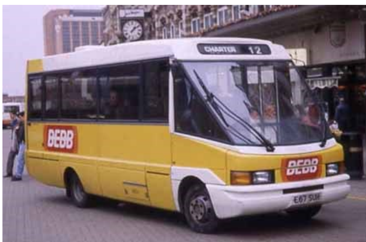
Slika 1.3 Optare CityPacer Minibus sa šasijom Volkswagen LT55
