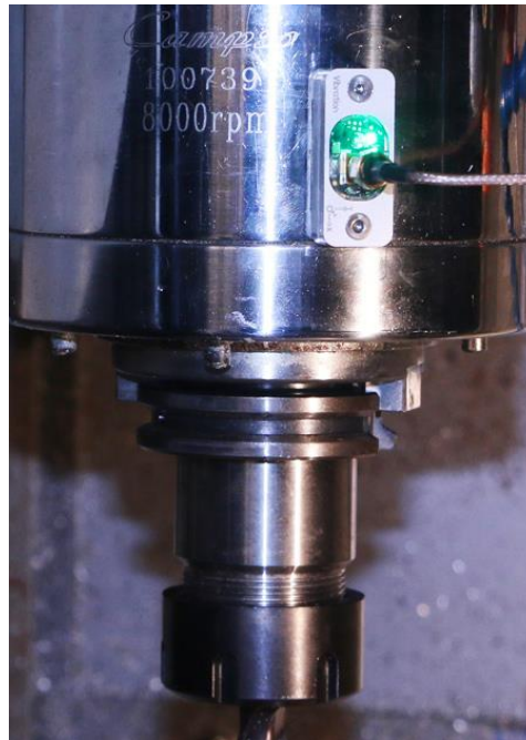
Slika 14. Primjer upotrebe senzora vibracija [27]
