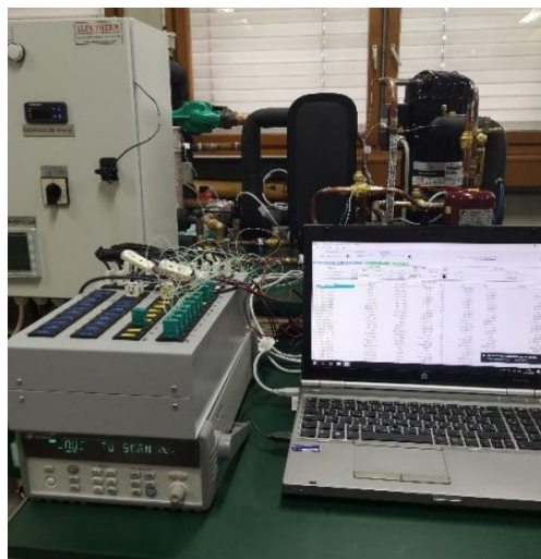
Slika 17. Akvizicijski sustav s A/D pretvaračem
