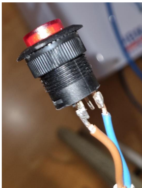
Slika 54. Žica i prekidač spojeni lemom
