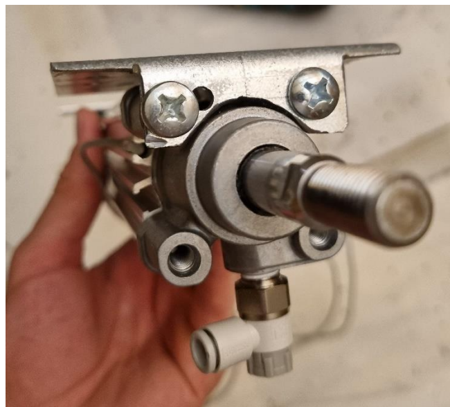
Slika 25. Kutni profil za pričvršćivanje cilindra
