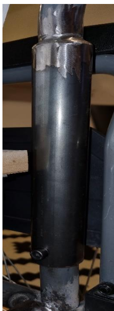
Slika 30. Teleskopska šipka za podešavanje visine
