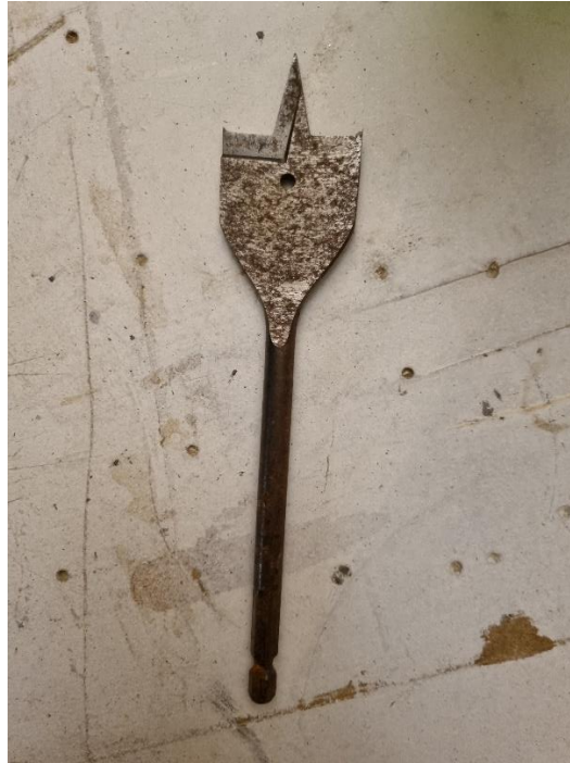
Slika 14. Svrlo \text{\O}32 korišteno za bušenje rupa
