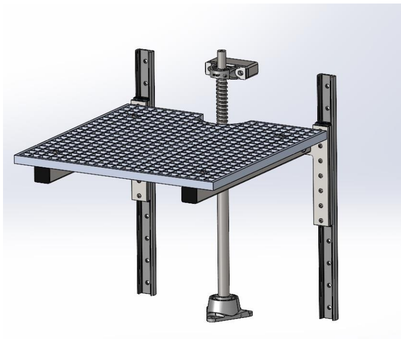
Slika 5. Gornji pogled 3D modela pokretnog dijela gazišta
