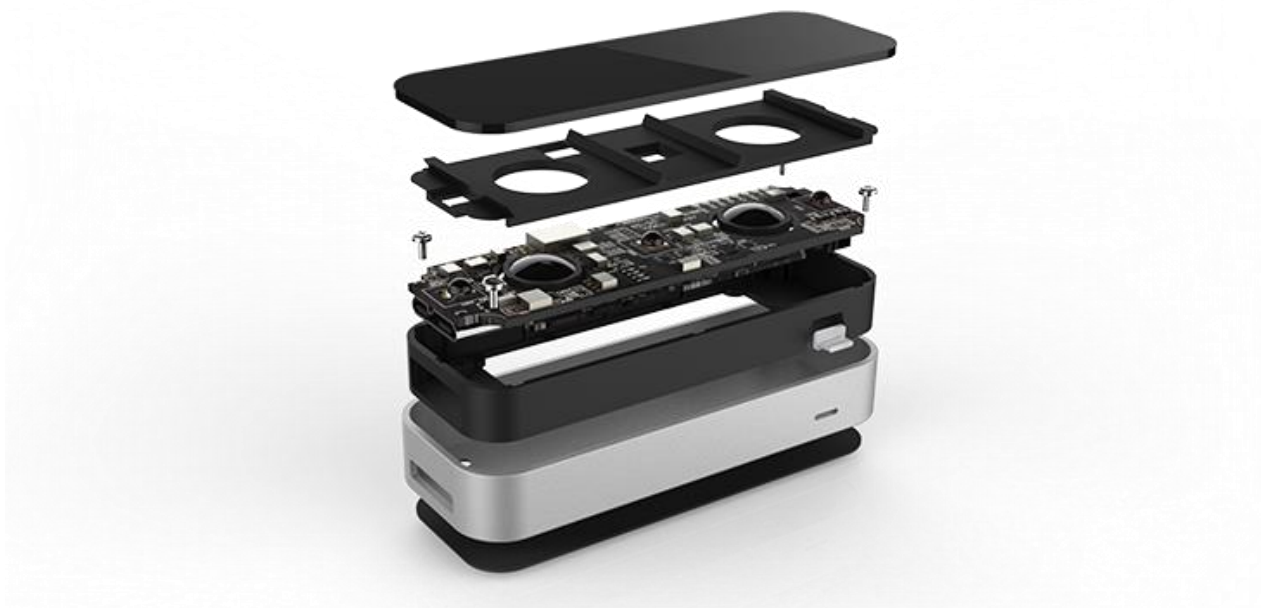
Slika 2. Struktura Leap Motion Kontrolera [6]
