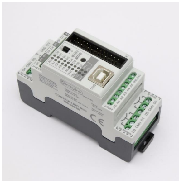
Slika 20. Upravljački uređaj Controllino mini
