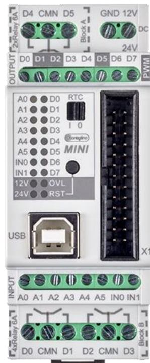
Slika 21. Priključci za Controllino mini
