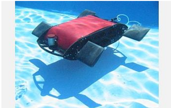
Slika 8. Plivajući mobilni robot [9]
