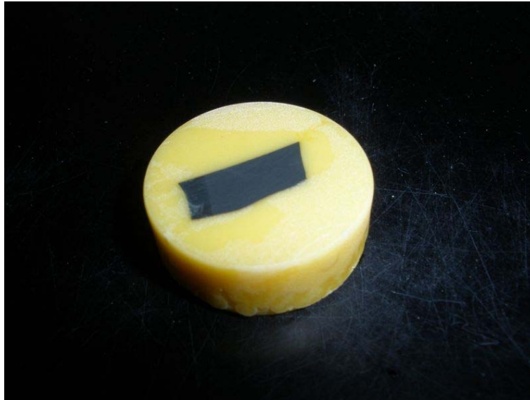
Slika 5. Izgled uzorka nakon zalijevanja
