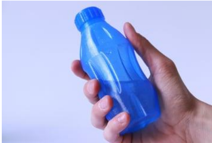
Slika 31. Tvorevina izrađena od Polietilena Tereftalata Glikola – PETG [42]
