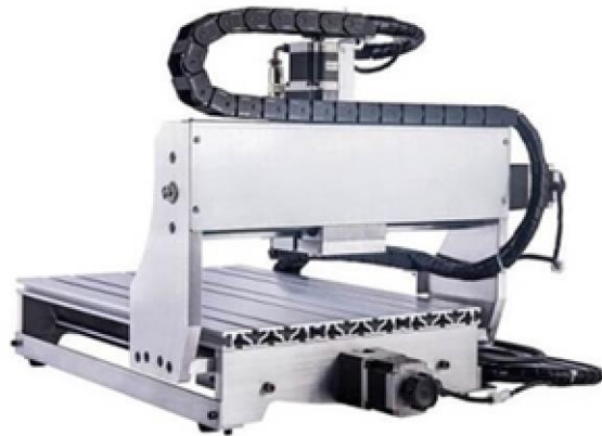
Slika 8 Mini CNC 3040 niskobudžetna tro-osna CNC glodalica [9]
