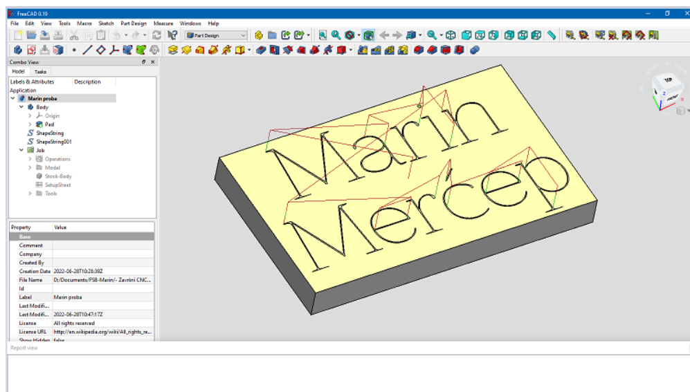
Slika 71. Primjer modeliranja graviranja teksta na pločici 3 x 5cm debljine 5 mm na javno dostupnom softveru FreeCad 0.19
