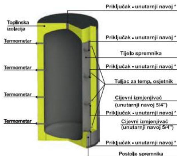
Slika 3.11. Centrometal CAS 301 s pripadajućim elementima unutar spremnika
