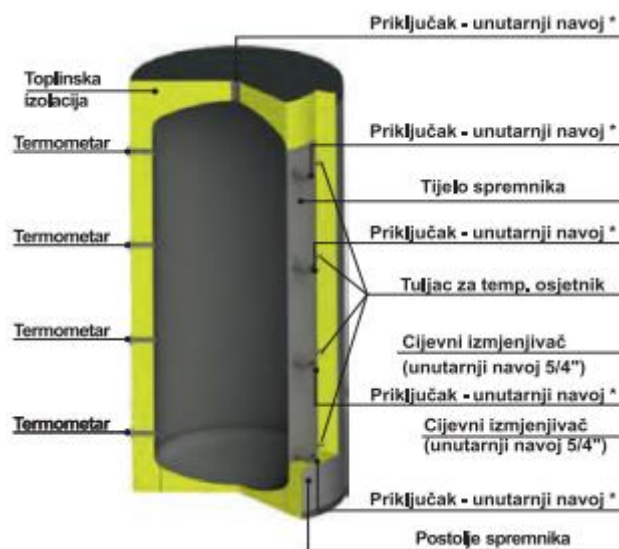
Slika 3.11. Centrometal CAS 301 s pripadajućim elementima unutar spremnika
