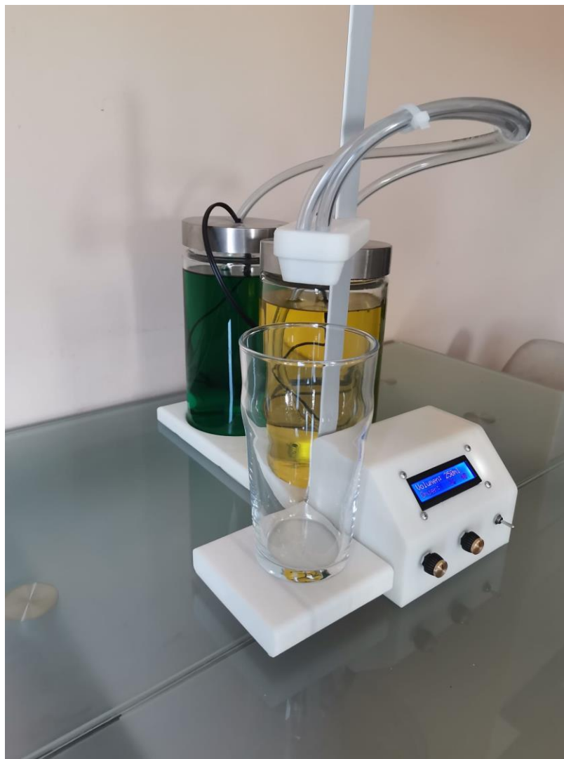
Slika 1. Automatizirani sustav za miješanje tekućina u definiranom omjeru
