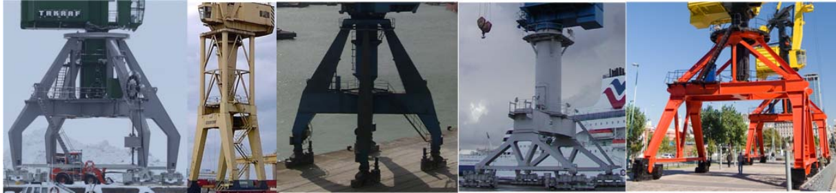
Slika 9.1 Razni oblici konstrukcije portala
