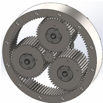
Slika 10. Planetarni reduktor 1UV s 3 planetarna zupčanika
