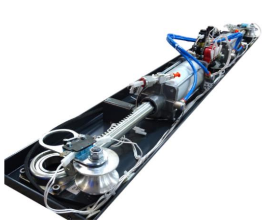
Slika 1. Pneumatski mehanizam vrata [6]
