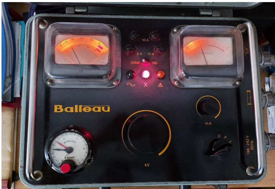
Slika 21. Upravljačka jedinica i parametri snimanja
