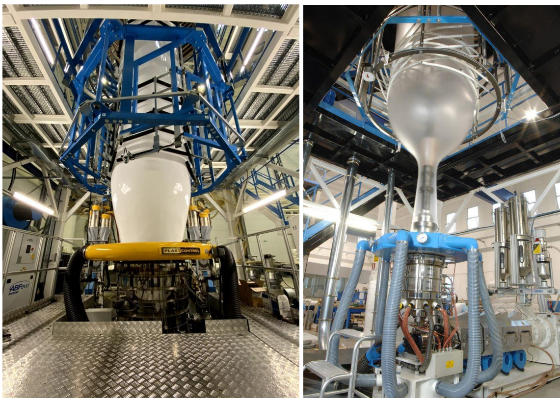
Slika 3.3. Ekstrudiranje LDPE filma [12], HDPE filma [13]
