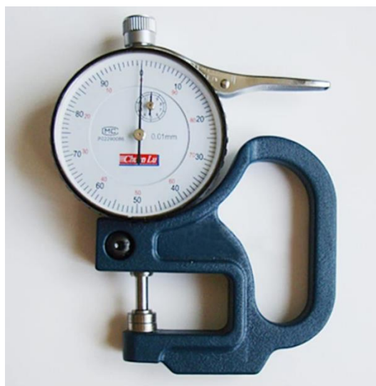
Slika 4.2. Uređaj za mjerenje debljine filmova i folija [22]
