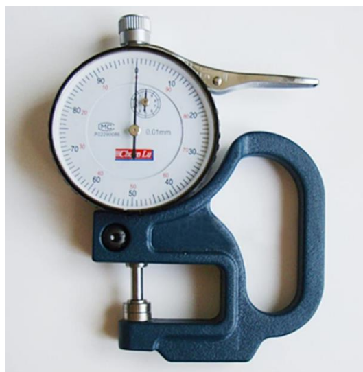
Slika 4.2. Uređaj za mjerenje debljine filmova i folija [22]
