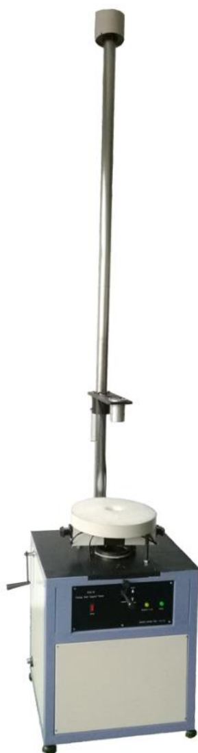
Slika 4.4. Uredaj za provođenje postupka ispitivanja prema normi HRN EN ISO 7765-1 [23]
