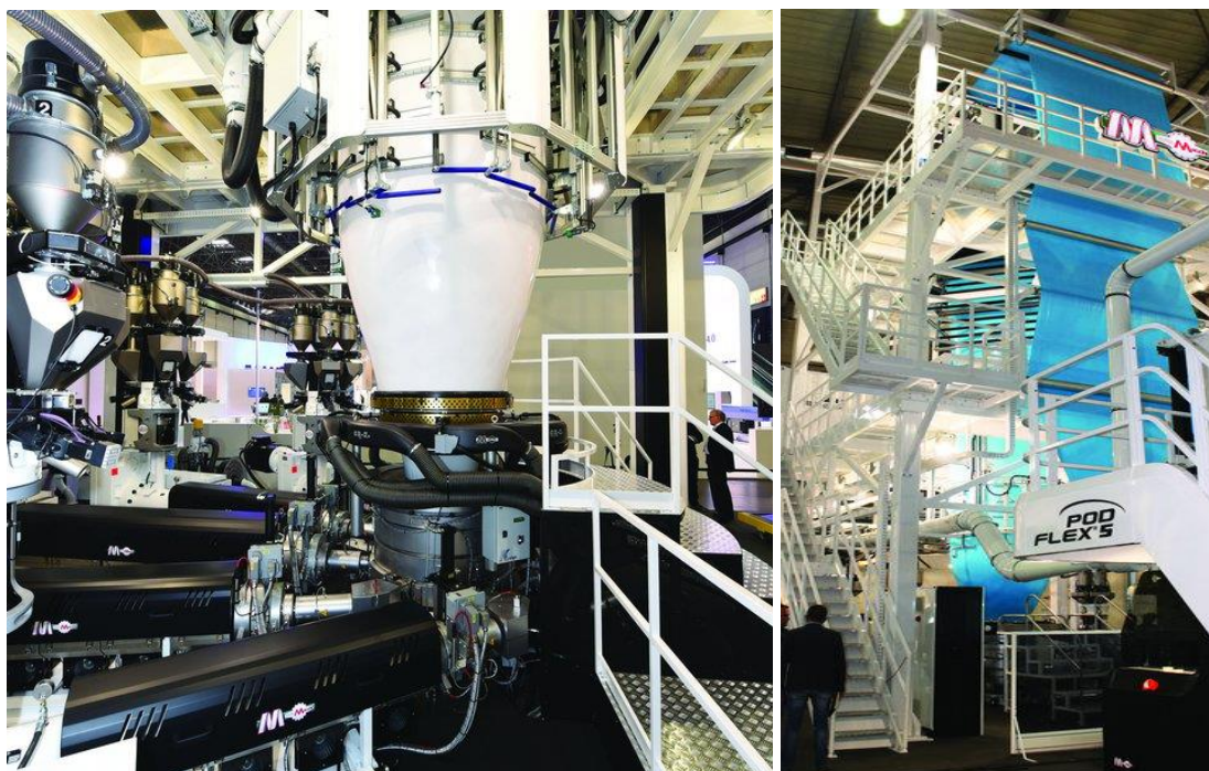
Slika 3.8. Ekstrudiranje crijevnog filma-pogon [13]
