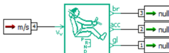
Slika 3.10. Komponenta modela vozača.
