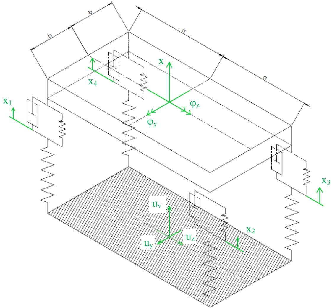
Slika 3.2 - Mehanički model sustava za vertikalnu uzbudu
