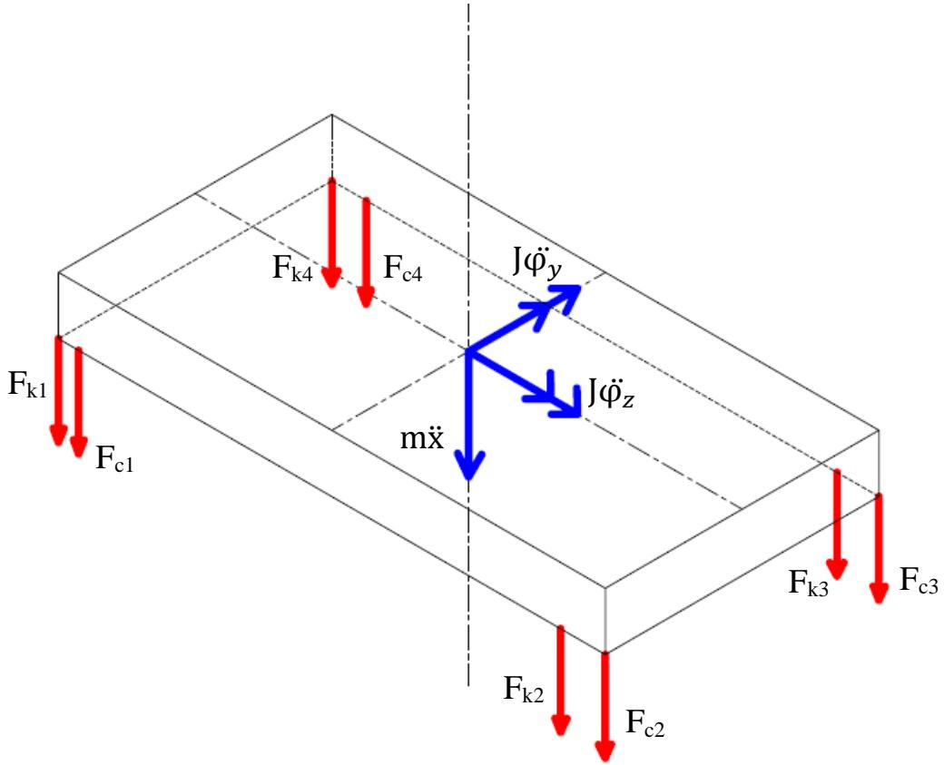
**Slika 3.4 - Sile na ploču uslijed horizontalne uzbude**
