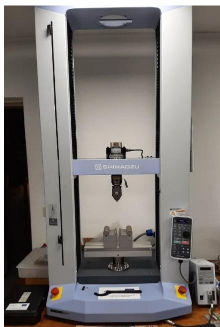
**Slika 12. Univerzalna kidalica Shimadzu AGS – X**
