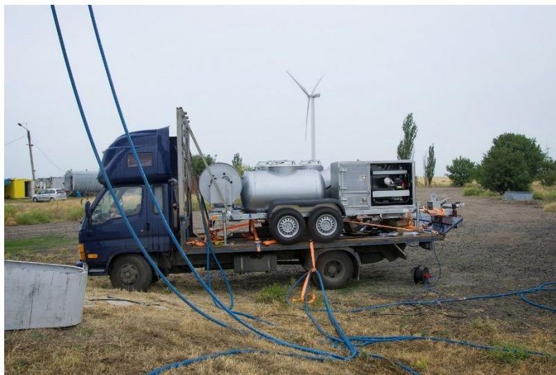
Slika 5: Uporaba stroja za izmjenu turbinskog ulja [13]
