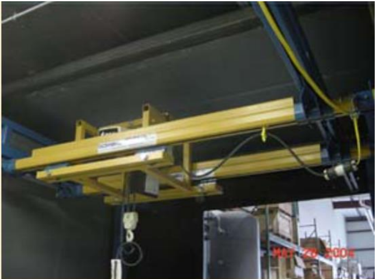
Slika 7. Stropni mosni granik tvrtke Gorbel [4]
