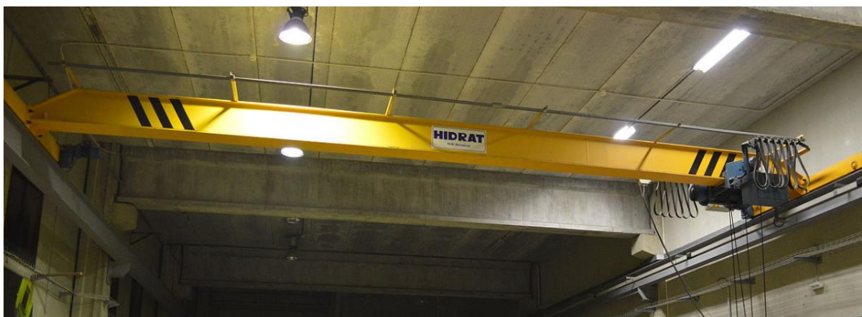
Slika 1. Mosni granik sa stazama postavljenim ispod stropa [1]
