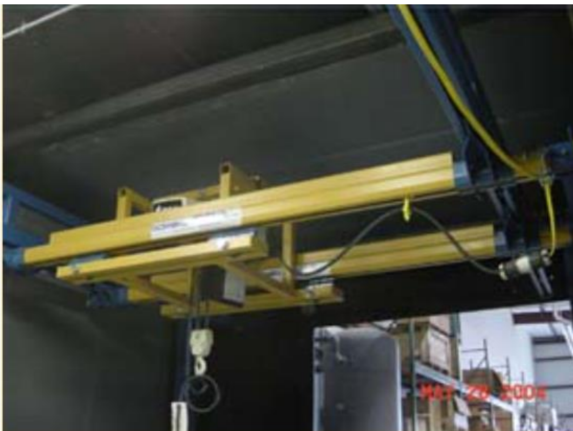
Slika 7. Stropni mosni granik tvrtke Gorbel [4]
