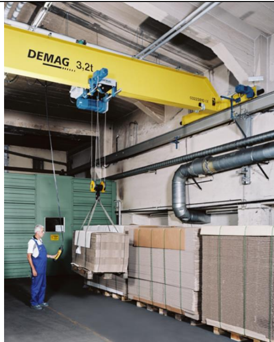
Slika 3. Mosni granik s jednim glavnim nosačem [1]
