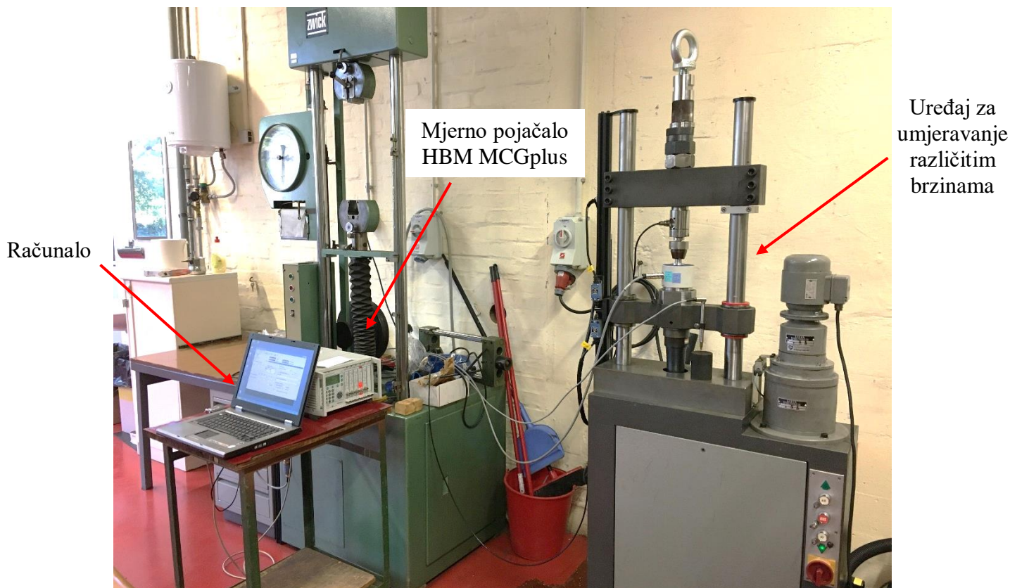
Slika 26. Kompletan sustav za provođenje umjeravanja različitim brzinama
